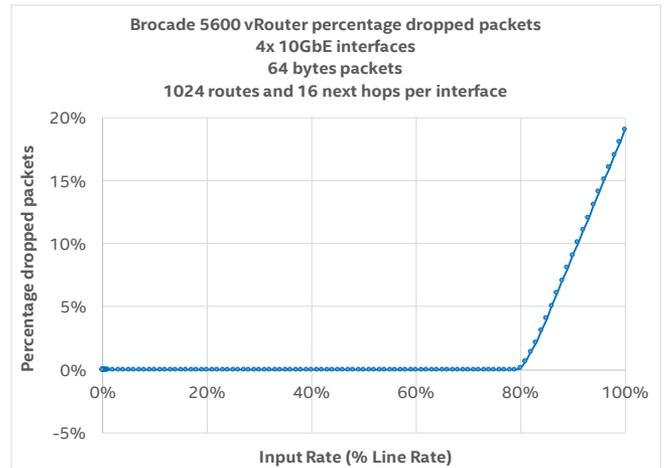
Figure 7. Brocade 5600 vRouter packet drop<sup>7</sup>
